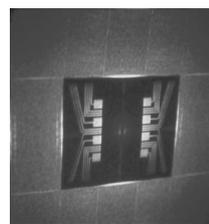
Fig.4 試作した DOE の像面強度分布
