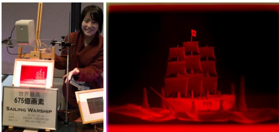
図2 大規模なバイナリ振幅型CGH「Sailing Warship II」
