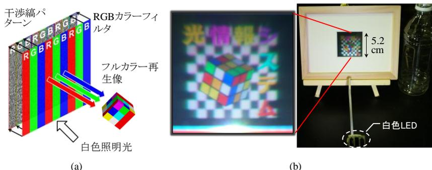
図 5 カラーフィルタ方式フルカラーCGH [3]. (a) 原理, (b)再生像
