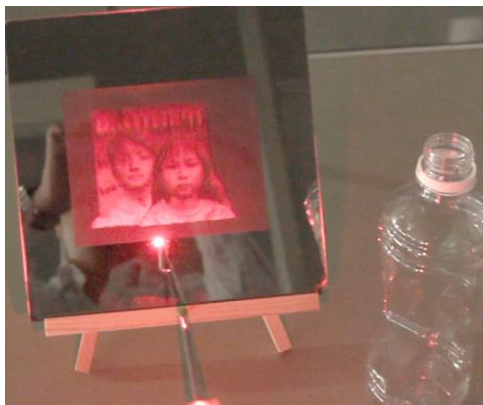
Fig. 8 Brothers の光学再生像(赤色 LED による反射再生).
