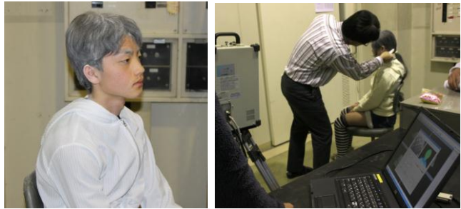
Fig.3 3Dレーザースキャナによるスキャンの様子。
