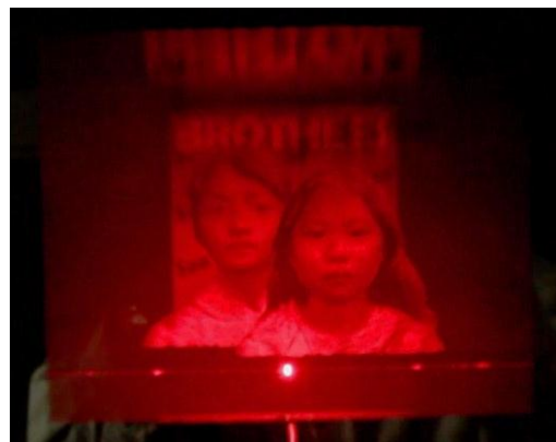
Fig. 8 Brothers の光学再生像(赤色 LED による反射再生).
