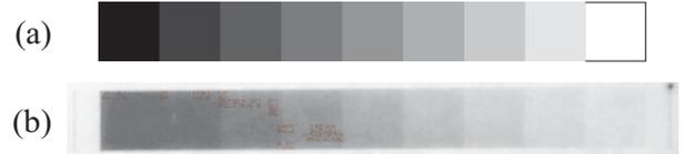
図 8 透過率測定用テストチャート . (a) 元画像 , (b) 描画像 .
